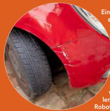
Ein Fahrzeuglackierer schaut sich den Schaden genau an. Bevor er die Fläche neu lackieren kann, bereitet er sie gründlich vor. Ganz glatt muss sie sein. Erst dann kann er sie mit frischer Farbe besprühen. Dazu verwendet er Spritzpistolen. Manchmal hilft ein Roboter mit.
